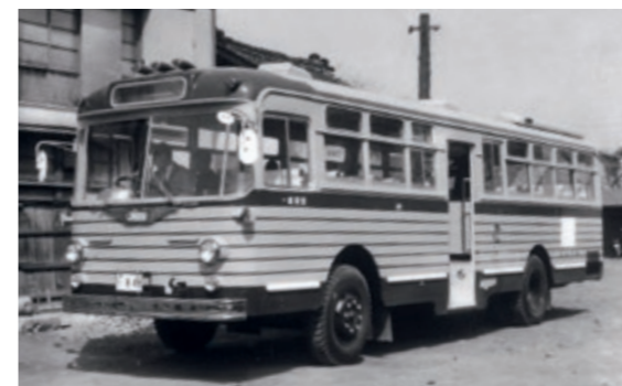
日野RE120型（昭和40年式） 全長10.02mのロマンスカー
