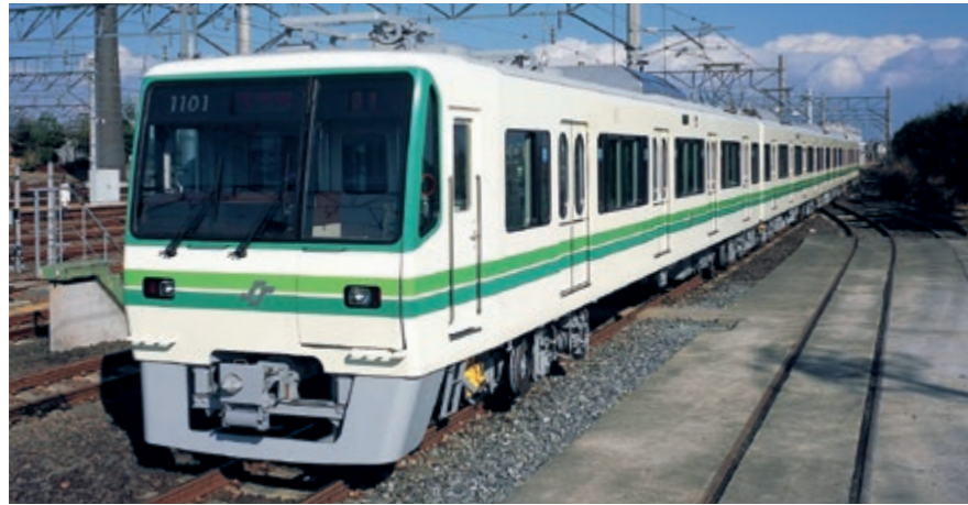
南北線 1000系 1000系車両は、ワンマン運転のための装置として、予見ファジィ方式自動列車運転装置や空間伝送光中継方式を用いた対列車画像伝送装置、モニタリング装置など、当時としては最新鋭の機器を導入しています。その結果、先進的な電車という高い評価を得て、「ローレル賞」を受賞しました。
