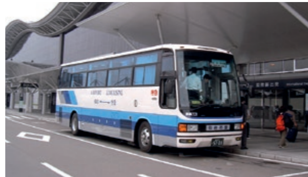
三菱U-MS729S (平成3年式) スーパーハイデッカー 貸切バスを改造して空港リムジンバスにした車両です。
