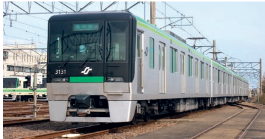
南北線 3000系 3000系車両は、車内カメラの導入、モーターとその制御装置に省エネ機器の採用など安全性・経済性の向上を図っています。また、低床化によるホームとの段差縮小、冷房能力の1.5倍向上、液晶式車内案内表示器の採用など、お客様サービスの向上を図り、外装デザインについては市民の皆さまの投票によって選定されました。仙台らしさを表現した内装や快適性向上が評価され、「2024 グッドデザイン賞」を受賞しました。
