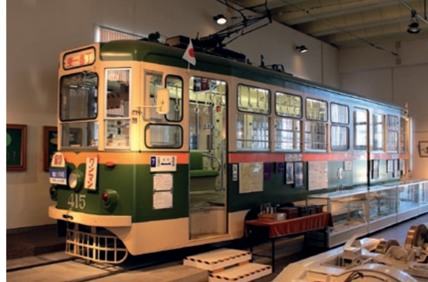
モハ400型 昭和38年4月に日本車両製造所で製作された全鋼製二軸ボギー車。仙台市電最後の新造車で、市電廃止まで活躍しました。軽量化と自動車部品を取り入れて保守性の向上を図っていました。 【市電保存館に展示されています。】
