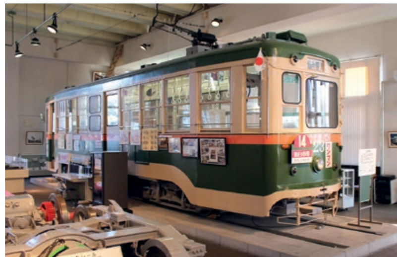
モハ100型 100型は仙台市電では最初の大型車。123号車は昭和28年3月に新潟鉄工場で新造された半鋼製二軸ボギー車で、市電廃止まで長く主力電車として活躍しました。 【市電保存館に展示されています。】
