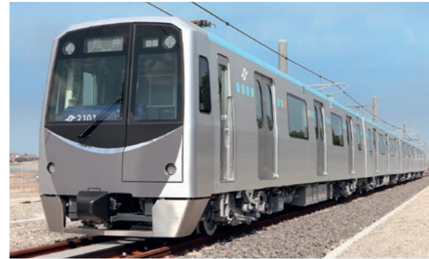
東西線2000系 2000系車両は、登坂能力に優れているリニアモータ方式を採用しています。また、台車には曲線通過性能が優れているリンク式操舵台車を採用することで、曲線走行時の騒音や摩耗の抑制を図りました。
