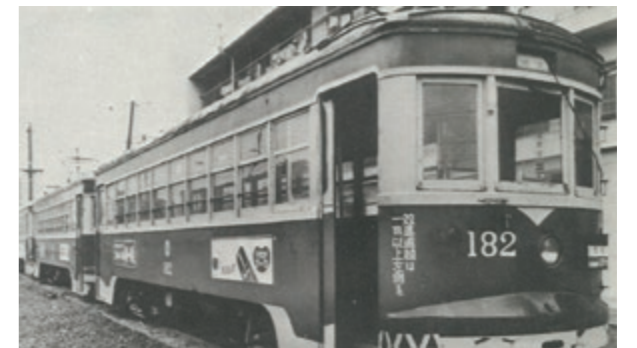
モハ180型 輸送力の増強を図る為、昭和39年に琴平参宮電鉄から譲受した半鋼製ボギー車。
