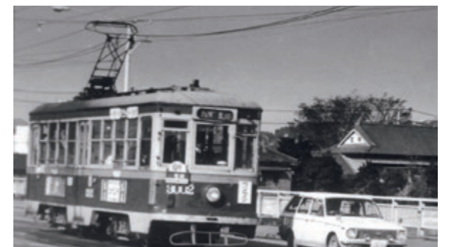
モハ3000型 呉市交通局から2000型とともに譲受した全鋼製ボギー車のワンマンカー。
