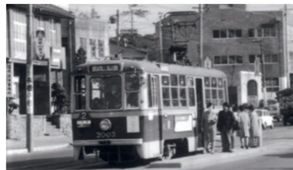
モハ2000型 昭和43年に路面電車を廃止した呉市交通局から譲受した全鋼製ボギー車のワンマンカー。
