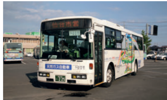
ガスボンベが床下にあるツースtep仕様車
