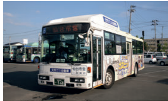
ガスボンベが屋根上にあるワンステップ仕様車
