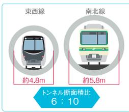
東西線と南北線のトンネル断面の比較
