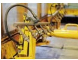
トンネルの水噴射して、トンネルとレールを洗浄する特殊車。トンネル洗浄用の大ノズルが2本、レール洗浄用の小さなノズルが14本も付いています!
