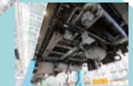
車体の下部分には、ブレーキ時に使用する空気を貯めるためのタンクが付いています。列車が駅を出発する時に聞こえる「ブリュー」という音の正体は、ブレーキ装置からエアが排出された時の音なのです
