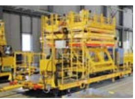
地下鉄東西線のトンネルは、最も高いところで7mあります。高所作業車は作業台を7mまで持ち上げることが可能なので、高いところの点検もお手の物!
