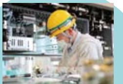
8年毎に行なう全般検査・4年または走行距離60万km毎に行なう重要部検査では、車両に取り付けてある数多くの部品をしっかりと確認します。20人にも及ぶスタッフが約2ヵ月半かけて作業にあたるんだとか
