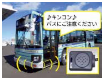
安全確認放送装置
