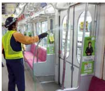
車両内の抗ウイルスコーティング作業（地下鉄）
