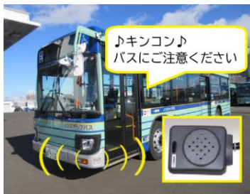
安全確認放送装置
