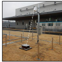
◆積雪計と積雪監視装置
