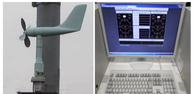
◆風向風速計と風向風速監視装置
