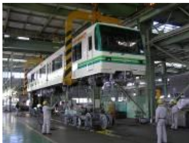
◆全般・重要部検査時の台車抜き作業
