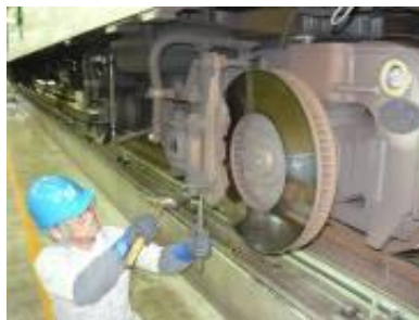
◆月検査時のディスク・ブレーキインゴ交換作業
