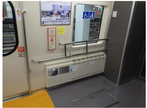
写真⑯ 車いすスペース・2段横手すり 非常通報器
