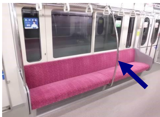
写真⑥ 縦手すり
