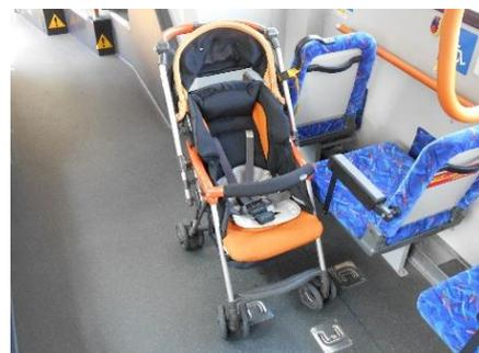
バス車内へのベビーカー用固定ベルトの設置
